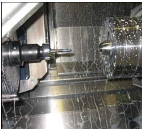
Obrábění v druhém vřetenu a finální výrobek
