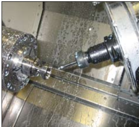
Dokončení obrábění v hlavním soustružnickém vřetenu a předání do druhého vřetene
